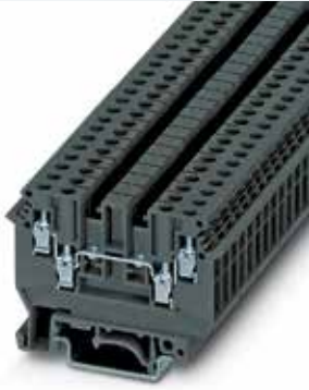
4 (6) мм 2 , 32 А, проходная клемма, 4 контакта
